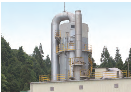
▲日本最大級のスプレードライヤー (蒸発量 850L/h)
